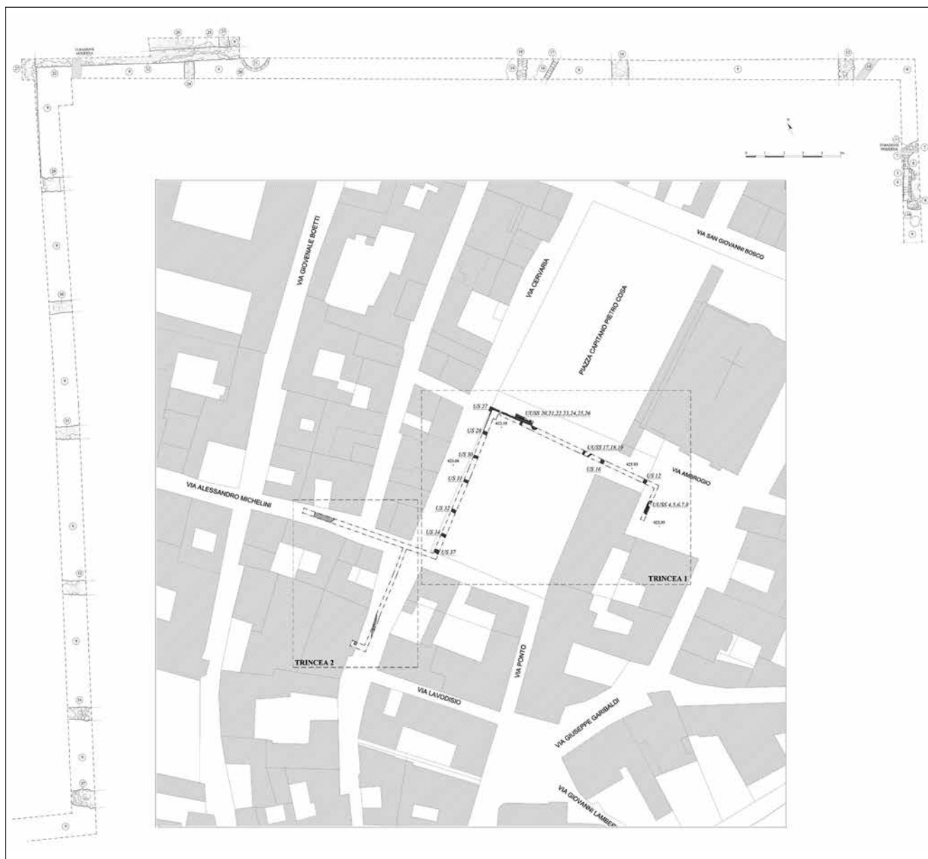
Fig. 94. Fossano, via Arendt (piazza Nicolaj), via Cervaria, via Michelini (scavi 2020). Posizionamento delle aree di scavo per il teleriscaldamento con assistenza archeologica (elab. F.T. Studio s.r.l.).
