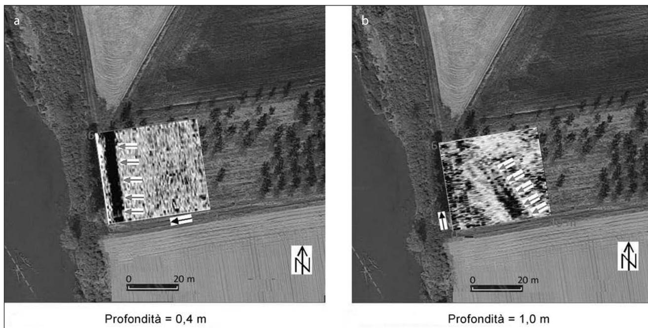
Fig. 163. Motta de' Conti, loc. Mantie. *Slices* ottenute con l'antenna da 500 MHz, relative a due differenti profondità; le frecce indicano le principali anomalie individuate (elab. S. Veronese).
