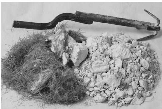
Fig. 25. Materiale rimosso dall'interno della cavità: gesso, paglia, perno in ferro (foto M. Magnasco).
