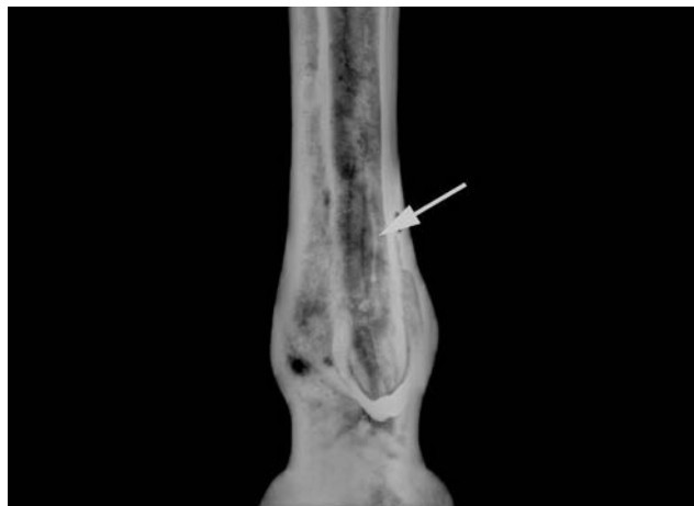
Fig. 22. Zampa di cavallo in bronzo. Gocciolatura tipica della tecnica di fusione a cera persa indiretta.
