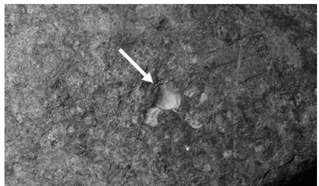
Fig. 20. Particolare della testa in cui si osserva un cratere (indicato con la freccia) dovuto al distacco di un aggregato di ossido di piombo (foto Archivio ex Soprintendenza Archeologia del Piemonte).
